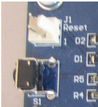
Abbildung 11: Reset-Taster und Stecker zum verbinden mit einem externen Reset-Taster
