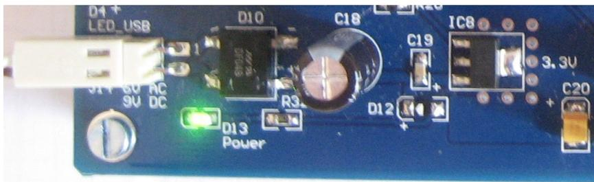
Abbildung 5: Aufbau der 3.3 Volt Spannungsversorgung
