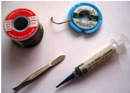
Abbildung 4: Hilfsmittel zum Arbeiten mit SMD-Technologie
